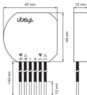
Zur Installation der Jalousiesteuerung J1 können die beigelegten Klemmen verwendet werden. Bei der Installation sind die allgemeinen Gefahren im Umgang mit Hausspannungsnetzen zu beachten!
