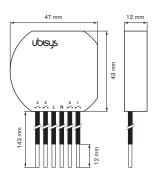
Zur Installation der Bedieneinheit C4 können die beigelegten Klemmen verwendet werden. Bei der Installation sind die allgemeinen Gefahren im Umgang mit Hausspannungsnetzen zu beachten!
