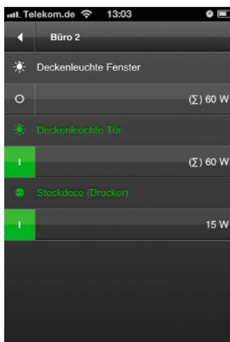
Wenn Sie mehrere Lampen über eine Komponente mit mehreren Ausgangskanälen aber nur einem Zähler (z.B. Leistungsschalter S2) ansteuern, wird die Summe ( $\Sigma$ ) des aktuellen Stromverbrauchs angezeigt. Die Summe wird bei allen Ausgängen angezeigt, da der Verbrauch keinem einzelnen Verbraucher zugeordnet werden kann.
